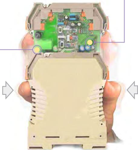
Se accede al interior de la tarjeta presionando las pestañas laterales y deslizando el frontal.
